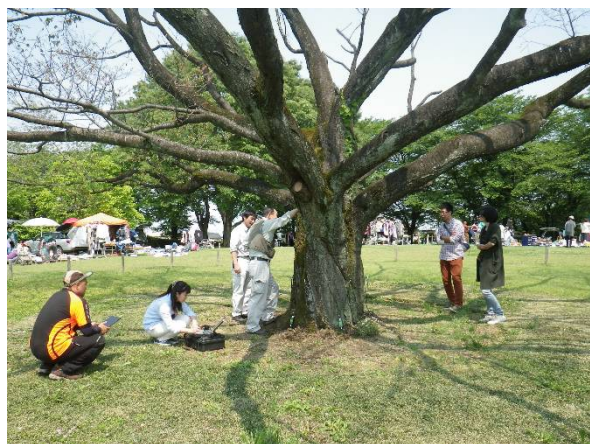
弾性波速度測定器によるヤマザクラの診断
