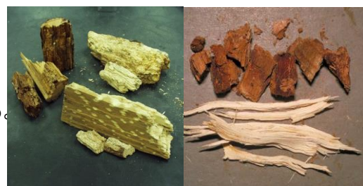
左: 白色腐朽 右: 褐色腐朽
